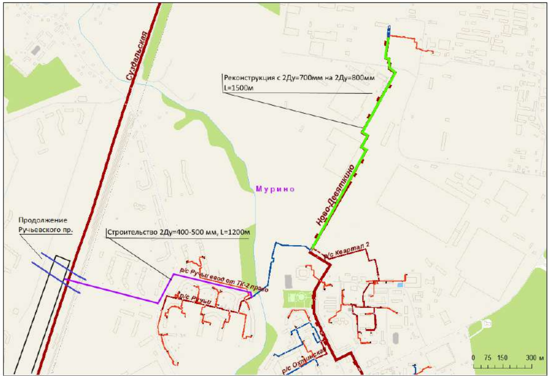
Рисунок 23. Вариант подключения ТПУ «Девяткино» от существующих тепловых сетей АО «Теплосеть Санкт-Петербурга»
